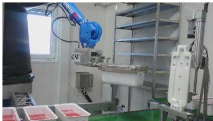
تصویر ۱۴ - ربات انجام دهنده مراحل لقاح بدون هیچگونه دخالت انسانی
